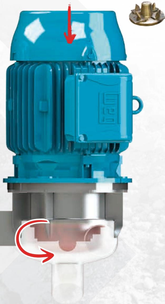
O sistema de reversão/trituração identifica automaticamente a necessidade de desbloqueio para triturar fibras dentro da voluta. Enquanto esse processo ocorre, a bomba reserva entra automaticamente em operação para evitar extravasamento.
